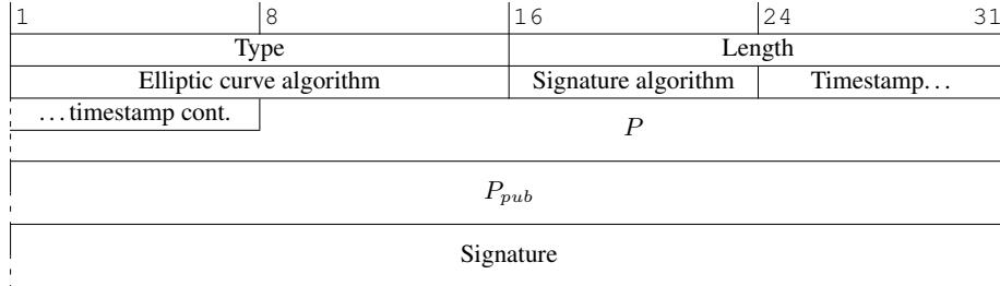
**Fig. 2.** HIP parameter structure for PKG public parameters.
