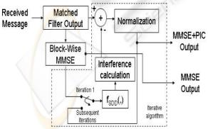
Figure 2 : PIC Structure
