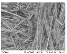
(d) The standard substances in tremolite
